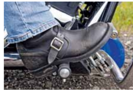
Victory: Bei normaler Fußstellung lässt sich die Bremse leider nur mit der Stiefelspitze erreichen (trotz Schuhgröße 44).
