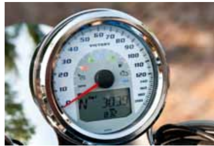
Victory: Offensichtlich ein Elektronikfehler: Die digitale Ganganzeige stimmt nicht mit dem tatsächlich eingelegten Gang überein.
