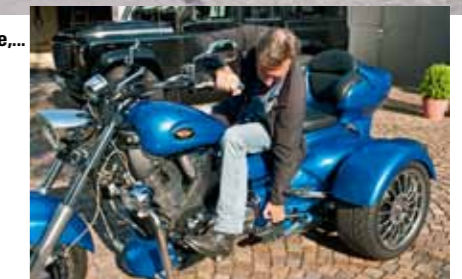
... bei der Victory nicht ganz so easy. Mit der rechten Hand wird am linken Lenkerende die Kupplung bedient, mit der linken Hand am Hebel (siehe Bild oben) ziehen, bis der mechanische Rückwärtsgang deutlich hörbar einrastet.
